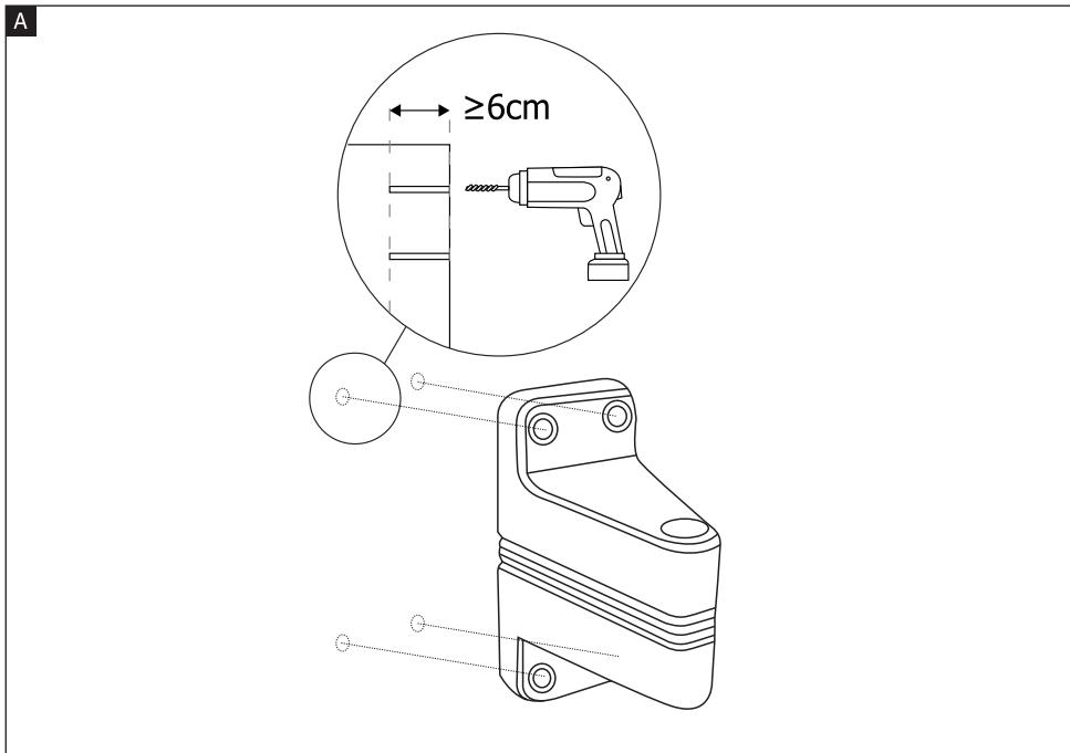
**FR** Percez les trous repérés précédemment à l'aide d'une perceuse et d'un forêt adapté. La profondeur des trous doit être d'au moins la taille indiquée.
