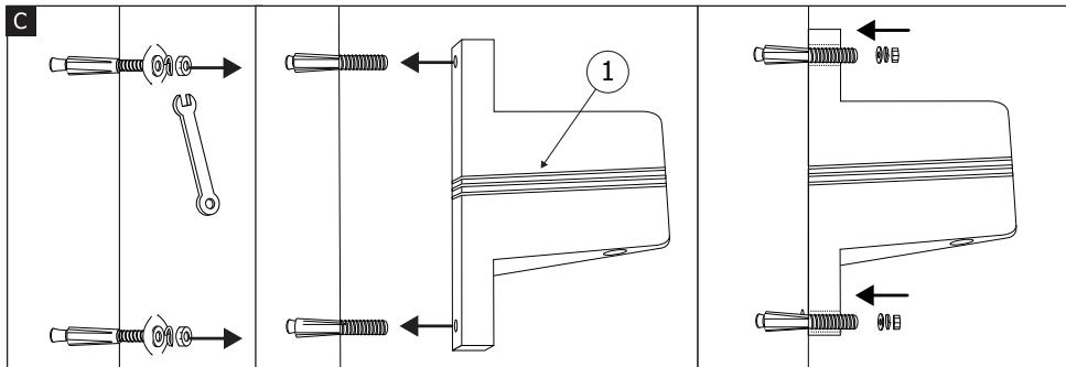
**FR** Une fois le tout solidement fixé, vous pouvez retirer l'ensemble des écrous et rondelles, placer le support mural (1) en vous assurant de respecter le sens de montage (flèche vers le haut), puis replacer rondelle, rondelle fendue et écrou, dans cet ordre.
