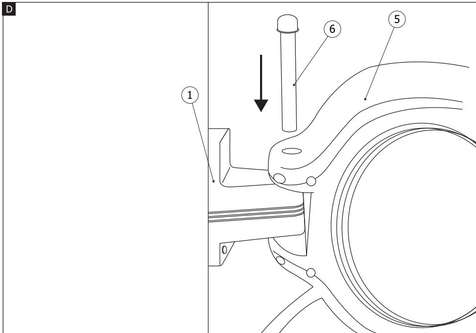
**FR** Vous pouvez alors placer l'enrouleur sur le support fraîchement installé puis sécuriser l'installation à l'aide de l'axe (6).
