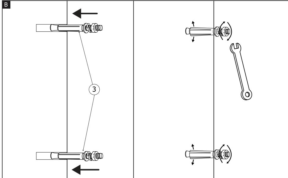
**FR** Une fois les 4 trous percés, enfoncez les chevilles à expansion (3) assemblées (avec écrou et rondelles) jusqu'à arriver en butée puis serrez l'écrou à l'aide d'une clé de 10mm, jusqu'à ce que la tige filetée soit solidement ancrée dans le mur. Répétez cette étape pour les autres fixations.
