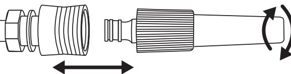
**FR** En sortie d'enrouleur, vous pouvez raccorder la lance d'arrosage ②. Vous pouvez alors ouvrir le robinet d'eau, et faire varier le jet en faisant tourner l'embout du pistolet.
