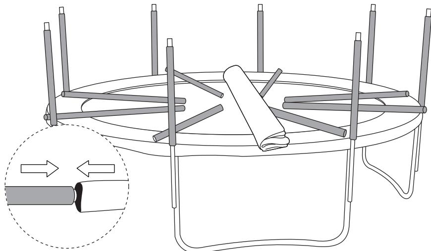
**FR** Insérez les montants supérieurs **N7** dans les fourreaux du filet **N5** prévus à cet effet (fourreau vers l'extérieur, filet à l'intérieur du trampoline).
