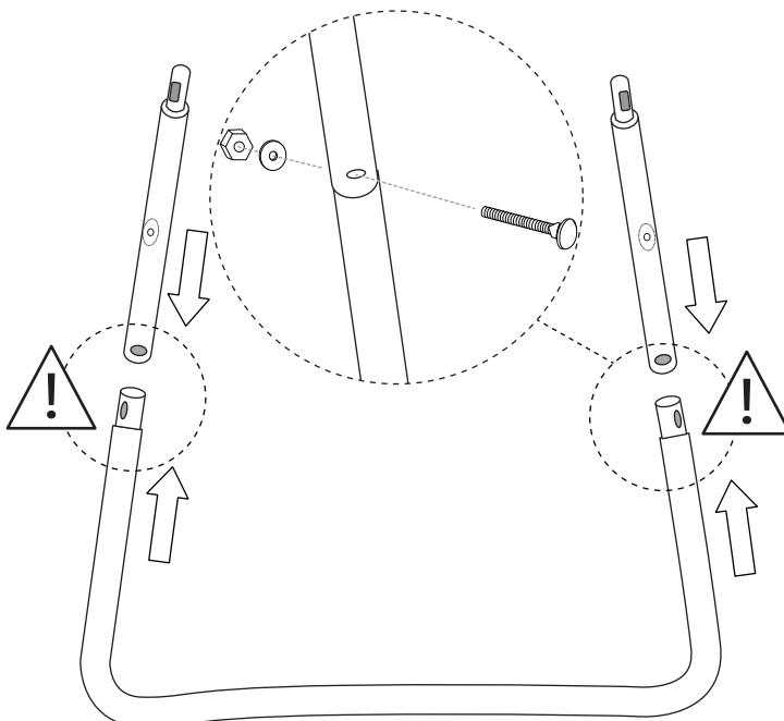
**FR** Assemblez les extensions de pied **Nº6** avec les pieds en U, vissez-les ensuite à l'aide des boulons **Nº12 (sauf Ø244cm)**. **⚠** Les trous du pied en U doivent être orientés vers l'extérieur.
