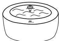
Setzen Sie den Spender in den Whirlpool. Vergewissern Sie sich, dass die Filterpumpe während des Desinfektionsvorgangs ausgeführt wird.
