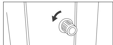
**OPMERKING:** Zorg ervoor dat de spa leeg is voordat u het onderdeel losschroeft. Schroef dit onderdeel nooit los als de spa gevuld is met water!
