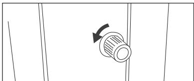
**NOTA:** antes de desenroscar la pieza, asegúrese de que el spa esté vacío. ¡No desenrosque nunca ese componente cuando el spa esté lleno de agua!
