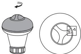
Drehen Sie die obere Kappe gegen den Uhrzeigersinn, bis die zwei Pfeile aufeinander ausgerichtet sind. Nehmen Sie die Kappe ab.
