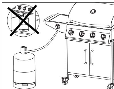
O espaço disponível sob o aparelho para armazenar o depósito de gás após o uso é: 671cm x 38cm x 49cm. Em caso de fuga de gás, desligue o fornecimento de gás.
