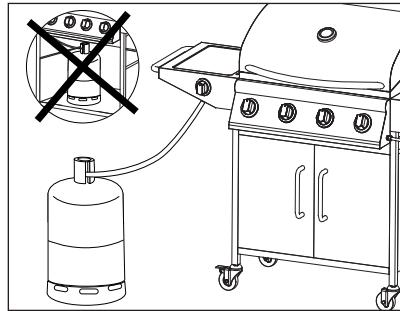
Der Platz unter dem Gerät, um die Gaspfandflasche nach Gebrauch zu verstauen, beträgt: 71cm x 38.5cm x 53.5cm. Im Falle eines Gaslecks unterbrechen Sie die Gaszufuhr.
