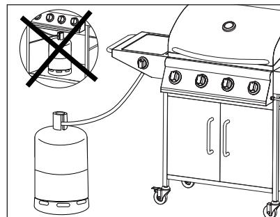
De beschikbare ruimte onder het apparaat om de gasafzetting na gebruik op te slaan is: 71cm x 38cm x 49cm. In geval van een gaslek, sluit de gastoever af.
