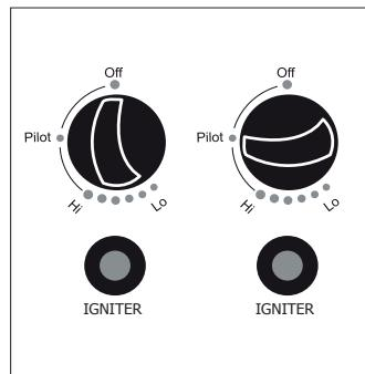
**!** **NOTA :** el quemador puede hacer ruido cuando se enciende por primera vez. Para que no esto no ocurra gire el botón de mando hasta la posición de llama piloto y vuelva a girarlo hasta la posición deseada.
