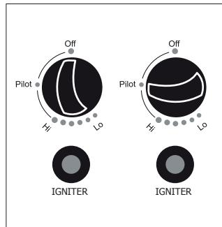
**!** **NOTA :** il bruciatore può emettere un rumore quando viene acceso per la prima volta. Per eliminare questo rumore, ruotare il pulsante di comando sulla posizione fiamma pilota. Quindi, ruotare nuovamente il pulsante fino a portarlo sulla posizione desiderata.
