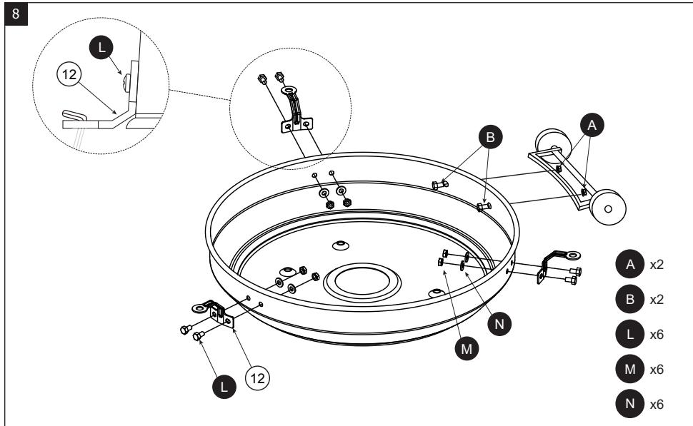
**FR** Installez les roulettes **11**, en vissant le support roulettes sur l'embase, à l'aide des 2 vis M8x16 **B**, et des écrous M8 **A**, puis serrez l'ensemble. Assemblez les 3 stabilisateurs **12** à l'aide des 6 vis M6x10mm **L**, des rondelles **N** et de leurs écrous **M** (2 boulons par stabilisateur). Fixez l'appareil au sol à l'aide des sardines ou de chevilles (non fournies)
