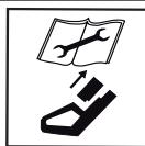
Entfernen Sie den Akku, bevor Sie Einstellungs-, Reinigungs- oder Wartungssarbeiten an der Maschine vornehmen.
