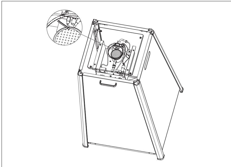
Si, pour quelque raison qu'elle soit, le bouton piezo **ALLUMAGE** ne fonctionne pas, vous pouvez allumer le parapluie chauffant à l'aide d'une grande allumette ou du porte-allumette fourni. Insérez l'allumette ou le porte-allumette par le trou du brûleur (schéma ci-contre) et en même temps, tournez le commutateur sur la position **PILOT**, tout en appuyant pour amorcer le gaz.
