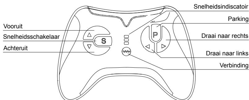
De afstandsbediening schakelt automatisch uit als deze 10 seconden niet gebruikt is.
