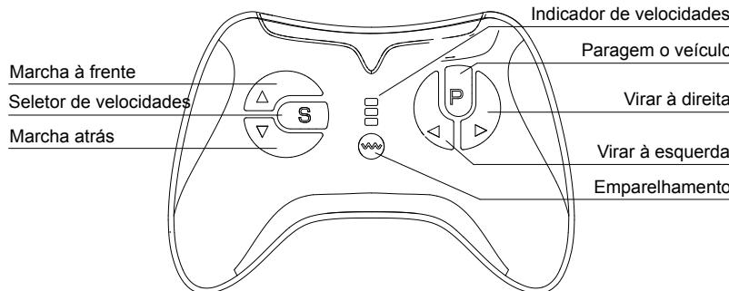
O comando à distância apaga automaticamente após não ser utilizado durante 10 segundos.
