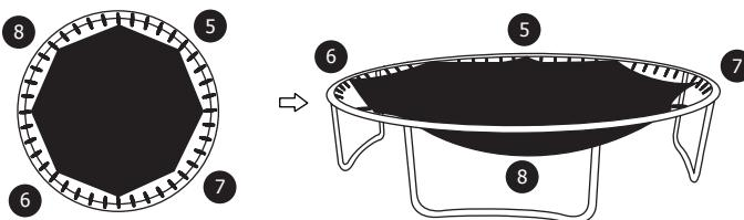
**FR** Positionnez les ressorts face-à-face de manière symétrique, afin de ne pas exercer trop de tension d'un côté. Entre deux ressorts montés, vérifiez que vous avez la même quantité d'attaches sur la toile que d'encoches sur la structure. Veillez à bien respecter l'ordre de montage ci-dessus afin de rendre la manipulation plus facile.
