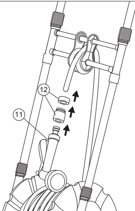
**FR** Vous pouvez alors raccorder votre enrouleur à votre arrivée d'eau en utilisant le nez de robinet et adaptateurs fournis. La partie la plus courte et fixe doit être reliée au nez de robinet préalablement installé.
