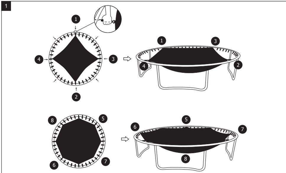
**FR** Positionnez les ressorts face-à-face de manière symétrique, afin de ne pas exercer trop de tension d'un côté. Entre deux ressorts montés, vérifiez que vous avez la même quantité d'attaches sur la toile que d'encoches sur la structure. Veillez à bien respecter l'ordre de montage ci-dessus afin de rendre la manipulation plus facile.
