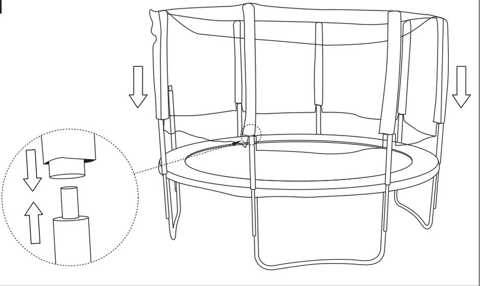
**FR** Assemblez maintenant le montant supérieur (avec filet) dans le montant inférieur, comme sur le dessin ci-dessus, puis faites glisser l'ensemble vers le bas. Placez l'entrée du filet au niveau des avertissements du coussin de protection afin qu'ils soient bien visibles par l'utilisateur.
