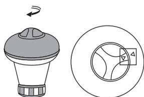
Tournez le couvercle supérieur dans le sens inverse des aiguilles d'une montre jusqu'à ce que les deux flèches se rencontrent. Retirez le couvercle.
