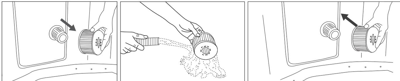
**OPMERKING:** Vervang het filterpatroon om de 3-5 dagen, of als het filterpatroon vuil en verkleurd blijft.
