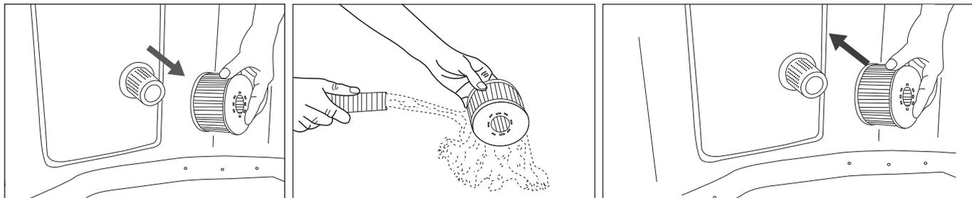
**HINWEIS:** Wechseln Sie die Filterkartusche alle 3–5 Tage, oder wenn die Filterkartusche verschmutzt und verfärbt ist.
