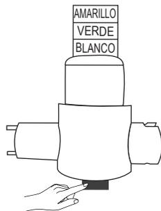
**ADVERTENCIA:** si el manómetro señala a la sección **blanca**, la presión del aire del spa es demasiado alta. Pulse el botón negro de la parte inferior del manómetro para soltar algo de aire hasta que el puntero vuelva a la sección **verde** o **amarilla**.
