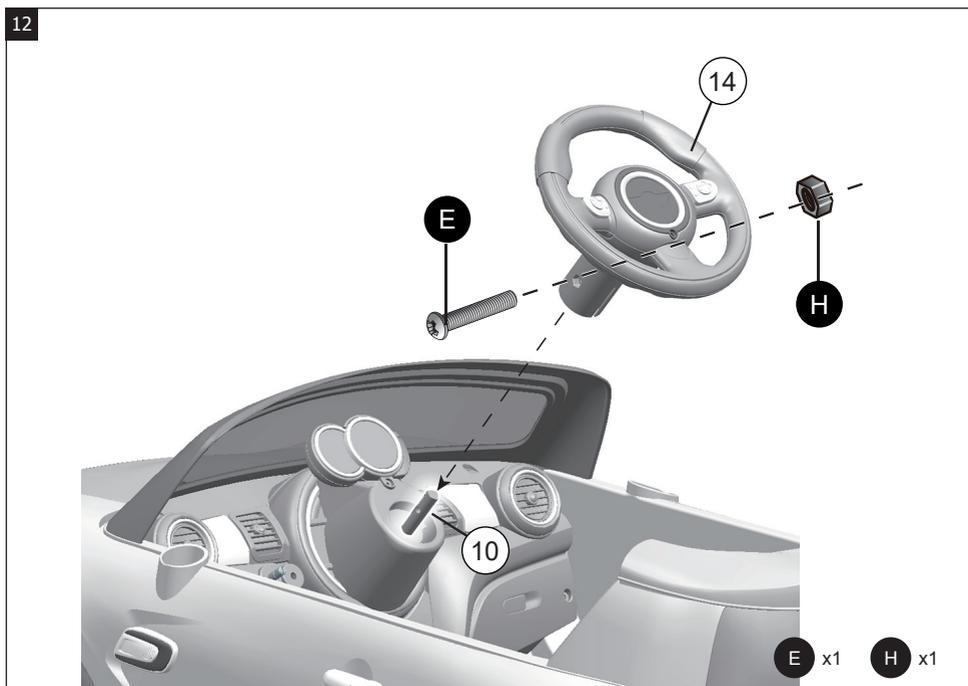
**FR** Dévissez la vis **E** et l'écrou **H** du volant. Alignez les orifices du volant et de l'axe de direction **10**, puis remplacez la vis **E** et vissez l'écrou **H**.
