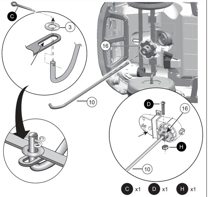
**FR** Placez la voiture sur le flanc et procédez à l'assemblage de la tringlerie de direction en retirant la boulonnerie pré-assemblée. Suivez le schéma ci-dessus.
