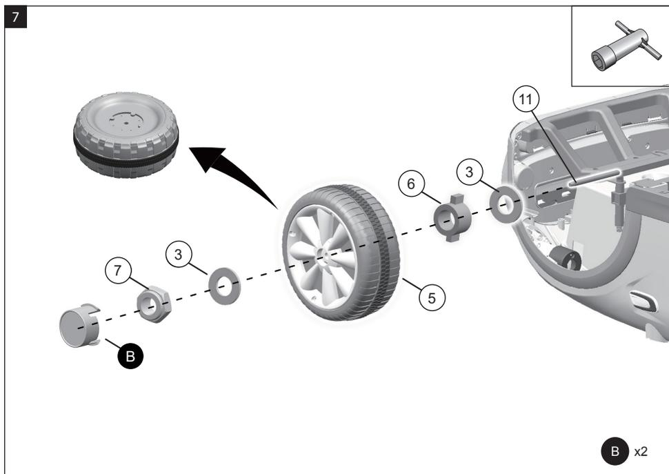
**FR** Retirez la quincaillerie préassemblée sur l'axe de roue avant, puis assemblez la roue directrice (5) en suivant le schéma ci-dessus. Répétez cette étape pour assembler la roue opposée.
