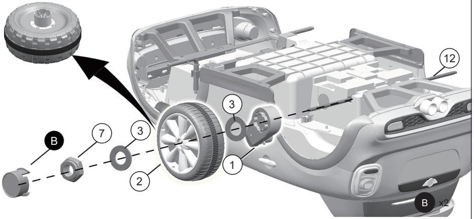
**FR** Insérez le moteur ① sur l'axe des roues ⑫ en suivant le schéma ci-dessus. Le moteur droit est étiqueté « R ». Le moteur gauche est étiqueté « L ». La roue motrice ② possède un orifice cranté à l'intérieur.
