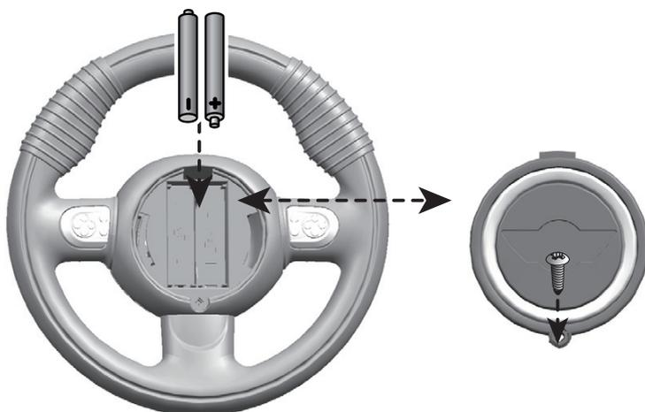
**FR** Retirez le cache au centre du volant en ôtant la vis, puis insérez deux piles AA (LR6).
