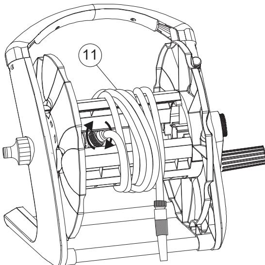
**NL** Vous pouvez alors raccorder votre enrouleur à votre arrivée d'eau en utilisant le nez de robinet et adaptateurs fournis. La partie la plus courte et fixe doit être reliée au nez de robinet préalablement installé.
