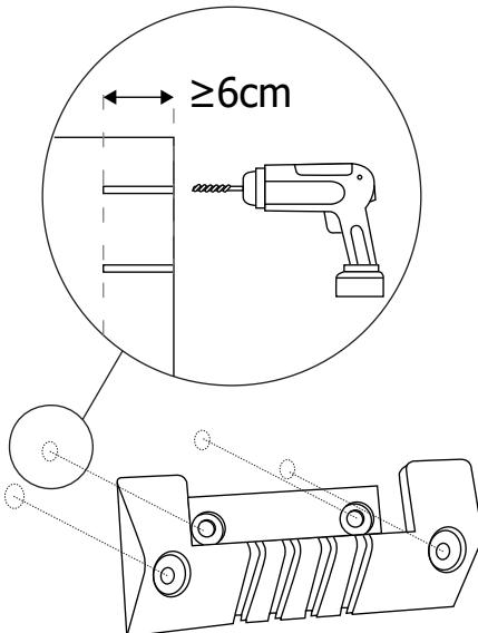
**FR** Percez les trous repérés précédemment à l'aide d'une perceuse et d'un foret adapté. La profondeur des trous doit être d'au moins la taille indiquée.
