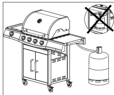
De beschikbare ruimte onder het apparaat om de gasafzetting na gebruik op te slaan is: 65x44x44CM. In geval van een gaslek, sluit de gastoever af.
