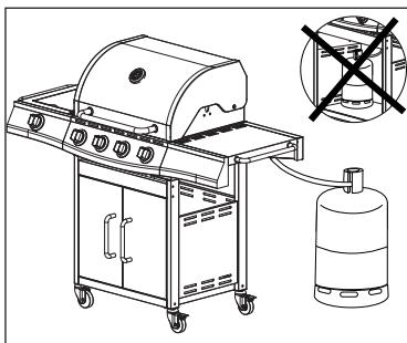
O espaço disponível sob o aparelho para armazenar o depósito de gás após o uso é: 65x44x44CM. Em caso de fuga de gás, desligue o fornecimento de gás.
