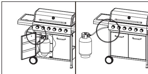
De beschikbare ruimte onder het apparaat om de gasafzetting na gebruik op te slaan is: 76 x 35.5 x 48cm.
