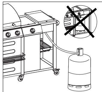
Der Platz unter dem Gerät, um die Gasflasche nach Gebrauch zu verstauen, beträgt: 71cm x 38.5cm x 53.5cm. Im Falle eines Gaslecks unterbrechen Sie die Gaszufuhr.
