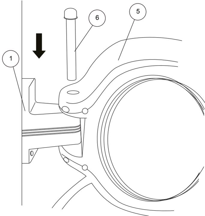
**FR** Vous pouvez alors placer l'enrouleur sur le support fraîchement installé puis sécuriser l'installation à l'aide de l'axe (6).
