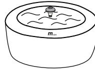
Drehen Sie die obere Kappe gegen den Uhrzeigersinn, bis die zwei Pfeile aufeinander ausgerichtet sind. Nehmen Sie die Kappe ab.
