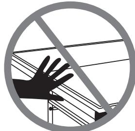
La table ne doit pas être poussée par les plateaux en position ouverte.
