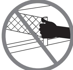
La table ne doit pas être déplacée en la tirant par les poteaux maintenant le filet.
