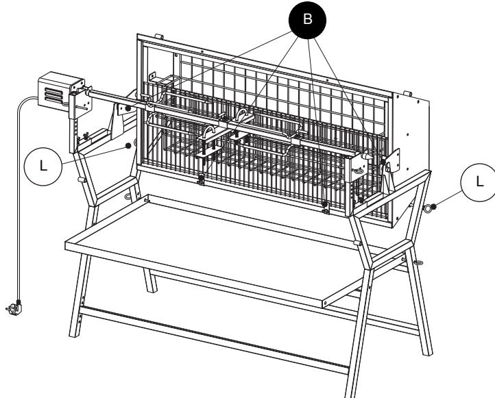
**FR** Avant de relever la cuve pour une utilisation verticale, vous devez retirer la petite grille (6) et vérifier que la grande grille (5) est bien fixée et sécurisée à l'aide des vis (B). Retirer les 2 goupilles (L), basculer la cuve à la verticale et la fixer à l'aide des 2 goupilles (L).
