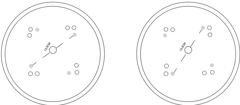
**FR** Identifier votre modèle de parasol puis identifier les trous à utiliser au dessus et en dessous de la base. Les trous identifiés au dessus doivent être de la même couleur que ceux du dessous.
