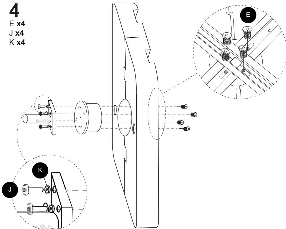
**FR** Placer les vis les unes en face des autres à l'aide des trous repérés à l'étape 1. Les trous doivent tous être de la même couleur.
